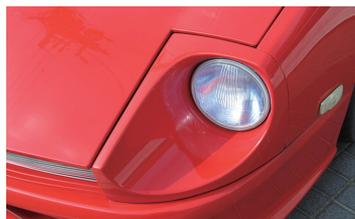
ライトケースは180SXの車両バランスに合わせ新たにデザインし製作されている。ヘッドライトは市販の180丸形ライトが使用可能だ。
