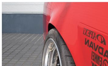
デモカーではワイドタイヤ装着のためにリアフェンダーを約100mm叩き出しているが、ビス止めタイプのオーバーフェンダーを装着するのも面白い。
