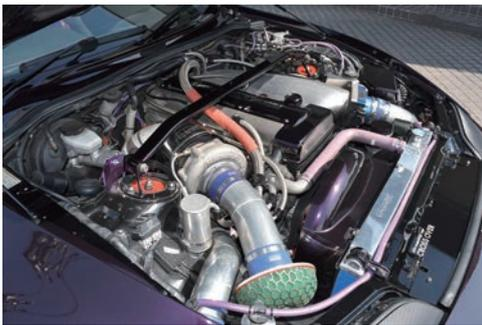
オリジナルは3リッターのNAエンジンというがHKSのT51RkaiタービンとVeilSideのサージタンクが装着され何と750馬力以上をたたき出す!!トルクも80Nmというから驚きだ。エンジン制御はAPEXのパワーFCでおこなうが車内から燃調が調整可能という。またハイカム、強化燃料ポンプ、3層インタークーラー、追加電動ファンなどの周辺にもしっかり手が入っているのは言うまでもなからう。
