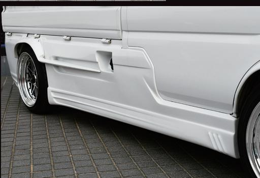
サイドパネルも「はろーすべしゃる」製だが実際はTTSで現車合わせしワンオフ加工し装着しているという。やはりレアな車種になると完全にフィットするのは無理。どうしても一部加工が必要となるが、TTSではラインを崩さずに加工し完璧な仕上げをしてくれる。
